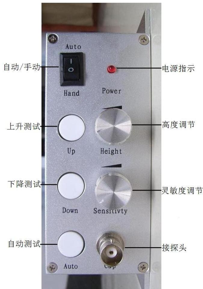
**Power** 电源指示：灯亮，表示电源已经接入。
