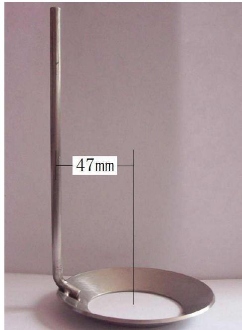
3、夹具视图：夹具的作用是用来将探头机构安装在割枪上，如下图所示：
