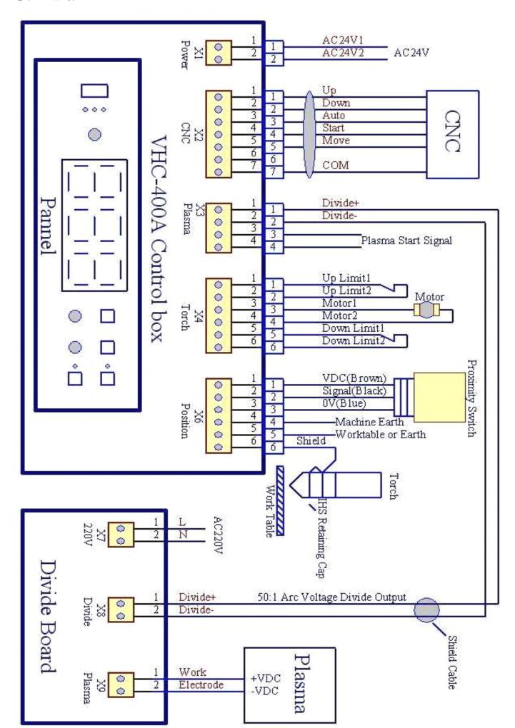
调高盒上一共有6组接口,分别是**X1-Power、X2-CNC、X3-Drive、X4-Plasma、X5-Pannel、X6-Position**。分压板上一共有3组接口,分别是**X7、X8、X9**。详细说明请见下面表格,接线前请参考接线图。
